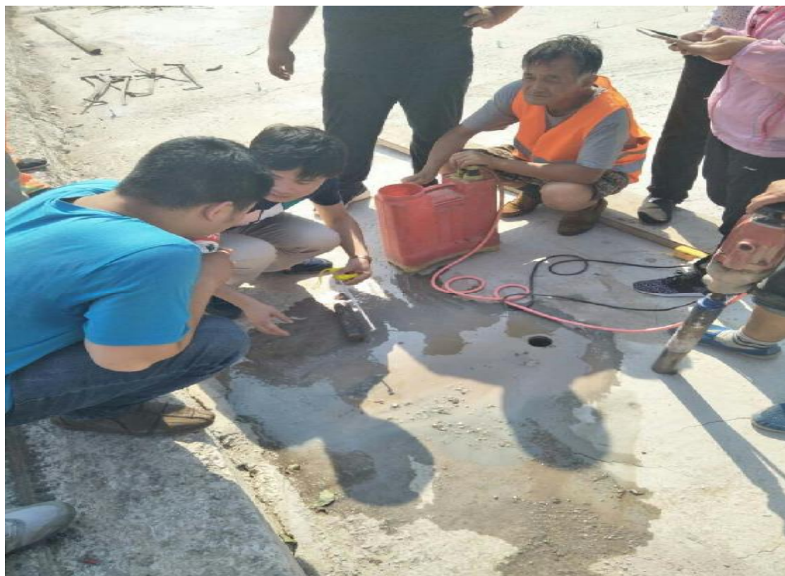
南宫收费站混凝土路面厚度钻心检测
