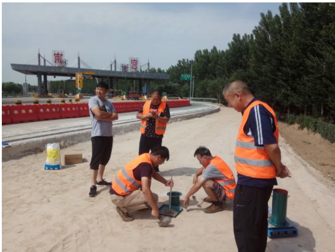
南宫收费站混凝土路面厚度钻心检测
