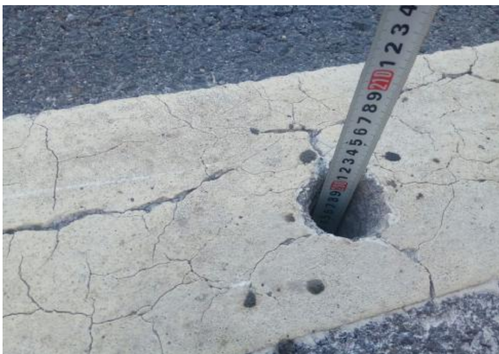
桥头跳车注浆孔现场深度检测
